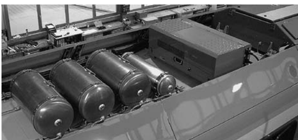
Bild 17: Beispiel für Dachaufbau mit begehbare Verkleidung
