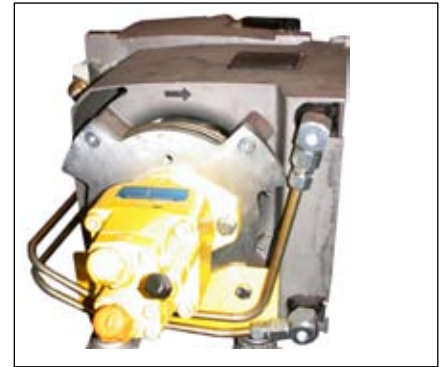
Bild 6: Antrieb mit Hydraulikmotor
