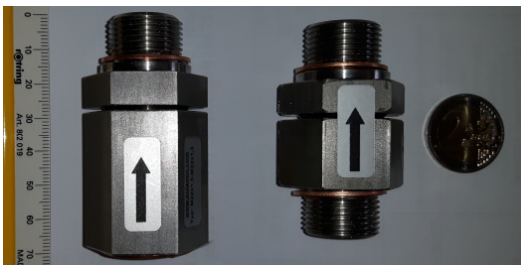
Bild 5: PDV- Beispiel für Ausführungen mit Innen- oder Außengewinde
