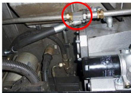
Bild 7: PDV – Einbaubeispiel eines PDV in einer DVA mit Zweikammertrockner in einem EMU, Ansaugvolumenstrom 800 l/min
