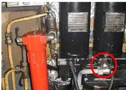
Bild 6: PDV – Einbaubeispiel eines PDV in einer DVA mit Zweikammertrockner in einer Straßenbahn, Ansaugvolumenstrom 600 l/min
