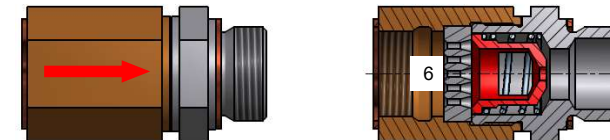
Bild 2 → PDV-DS (Eintrittseite Innengewinde, Austrittseite Außengewinde)
